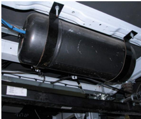
AGGIORNAMENTO PER IL MONTAGGIO DI UN SERBATOIO PER GPL, RISPONDENTE AL REGOLAMENTO N.R67 NON DESTINATO ALLA ALIMENTAZIONE DEL MOTORE (MARCA ICOM N.SERIE-7598 CAPACITA' LT.45+4)
