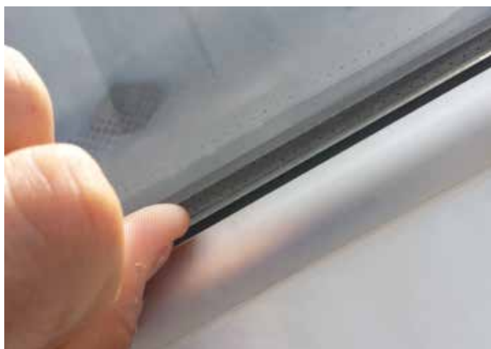
Una delle finestre difettose: si è aperta tra le 2 parti
