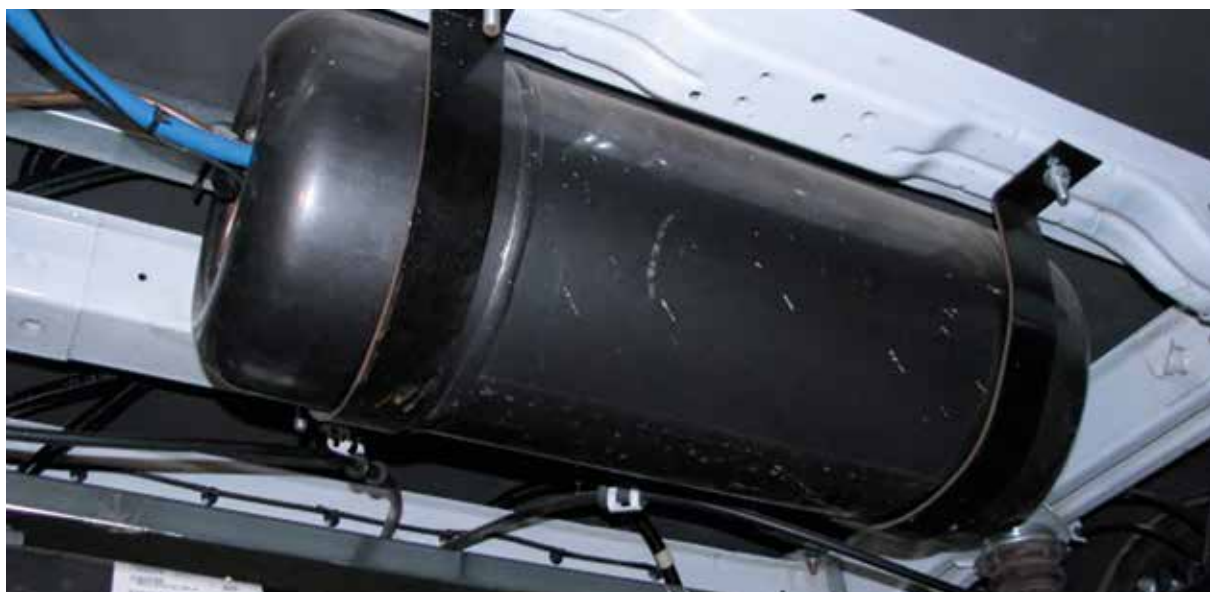
Esempio di installazione di serbatoio permanente di erogazione GPL per i servizi interni all'autocaravan
