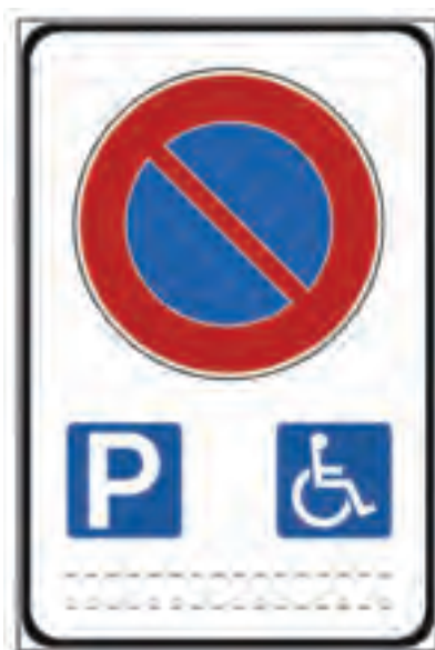
Figura II 79/a Art. 120" SOSTA CONSENTITA A PARTICOLARI CATEGORIE Sosta consentita ai veicoli al servizio di persone invalide munite dell'apposito contrassegno.
