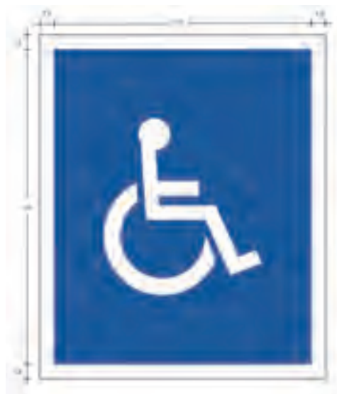
Figura V 5 Art. 381 SIMBOLO DI ACCESSIBILITA' (dimensioni in millimetri) Simbolo internazionale dell'accessibilità. Localizza percorsi o attrezzature costruiti nel rispetto della vigente normativa sulla eliminazione delle barriere architettoniche."
